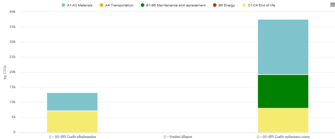
62. ábra 1. és 2. változat beépített anyagainak a globális felmelegedési potenciáljainak az összehasonlítása az életciklus egyes szakaszain keresztül (A és B1-B5 és C szakasz) Forrás: One Click LCA ábra
