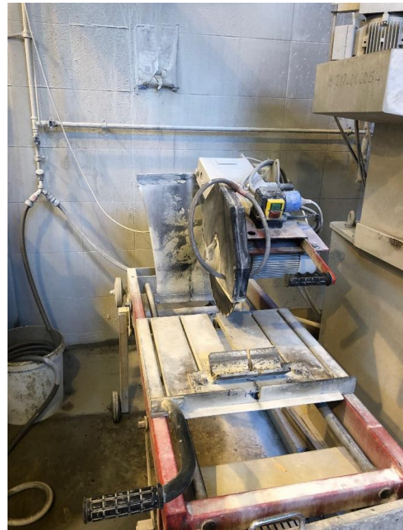
6. ábra: bal: peremes fagyhámlásnál használt légkeveréses fagyasztóberendezés jobb: próbatestek félbevágására és lesarkítására használt vágóberendezés
