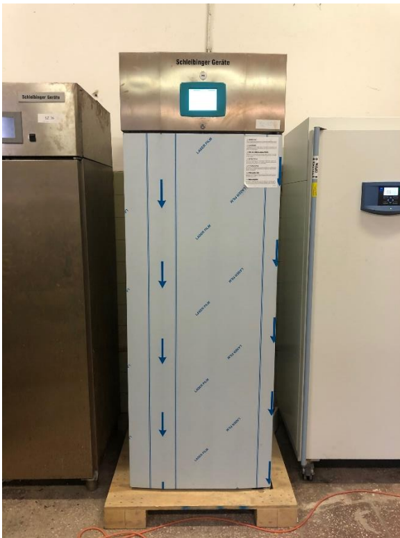
6. ábra: bal: peremes fagyhámlásnál használt légkeveréses fagyasztóberendezés jobb: próbatestek félbevágására és lesarkítására használt vágóberendezés
