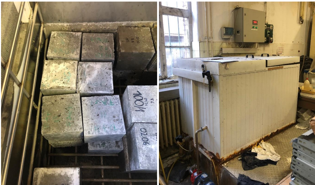
5. ábra: bal: próbatestek a bementéses fagyasztóberendezésben jobb: bementéses fagyasztás vizsgálatnál használt automata vezérlésű berendezés
