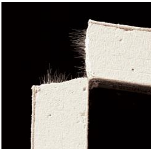
2.14 ábra: Tűzálló gipszkarton üvegszál erősítése [6]
