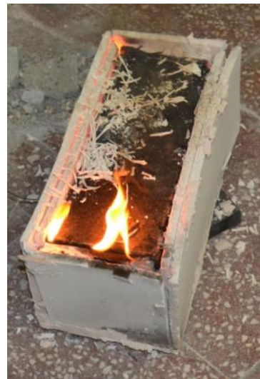
4.11 ábra: Lángoló polimerbeton próbatest a burkolatban
