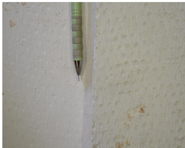
4.20 ábra: A gipszrostlap felülete hőterhelés előtt (bal) és után (jobb)
