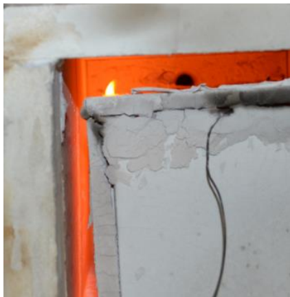
4.11 ábra: Lángoló polimerbeton próbatest a burkolatban
