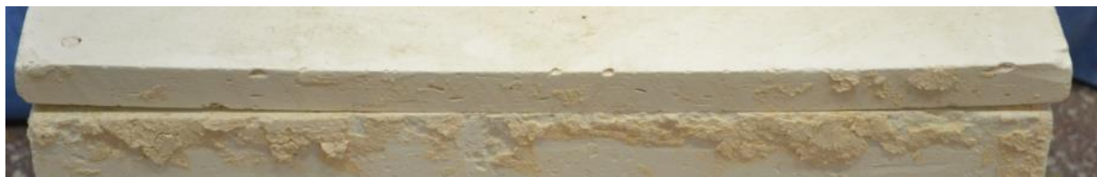
4.22 ábra: Eldeformálódott cementkötésű lap
