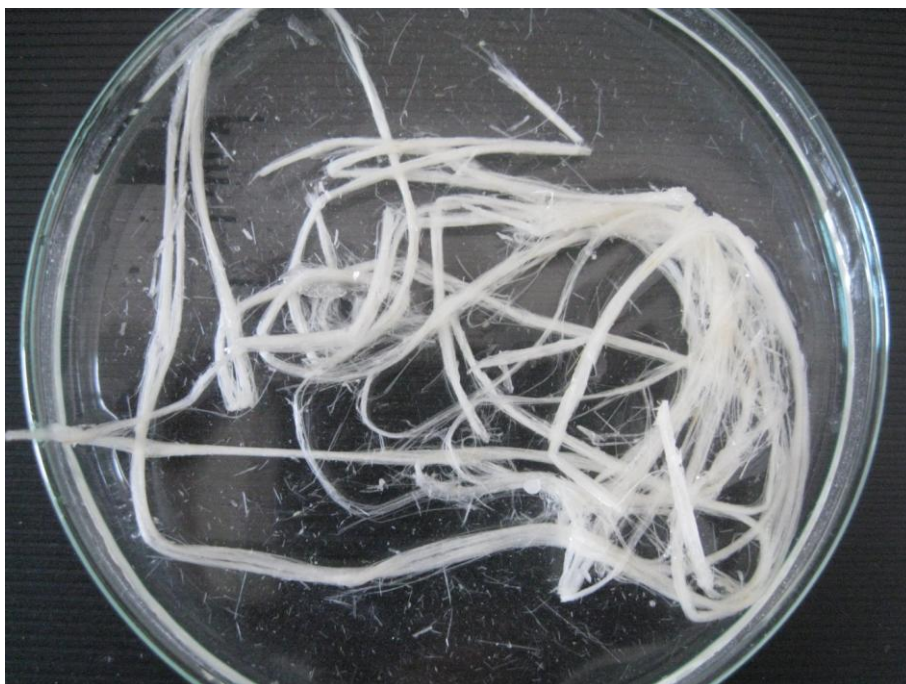
XX. ábra: Paraffin kezelés + tárolás Lawrence oldatban, kötegek szétestek, de csak mérsékelten oldódott
