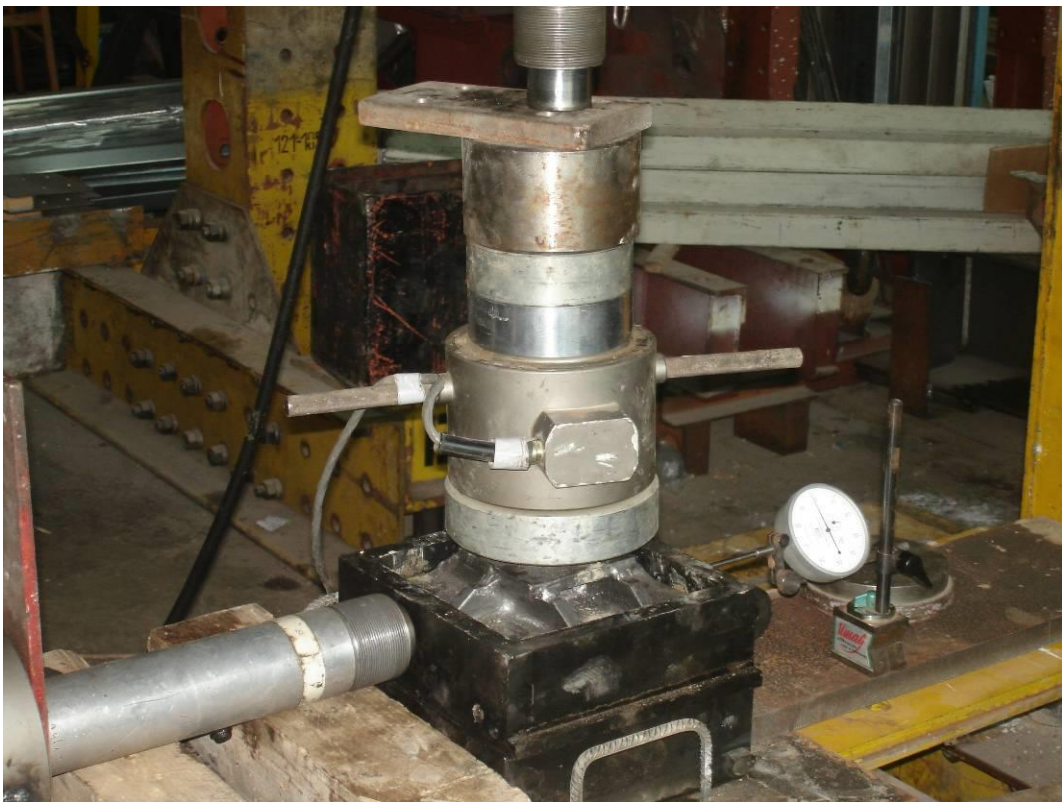
21. ábra: Szálerősítés hatásának vizsgálata közvetlen nyírókísérlettel [21.]
