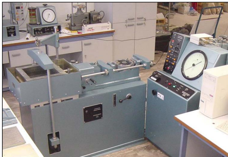
6. ábra: Közvetlen nyírókísérlethez használt berendezés [3.]
