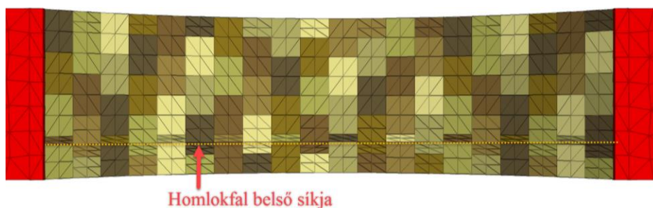
14. ábra – Létrehozott tönkremeneteli sík homlokfal elválásának vizsgálatához
