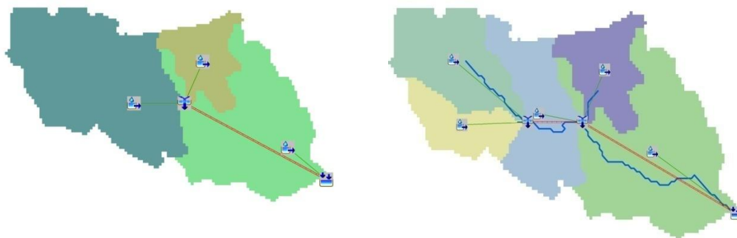
11. ábra: Vízgyűjtő modell három és öt részvízgyűjtővel, HEC-HMS.
