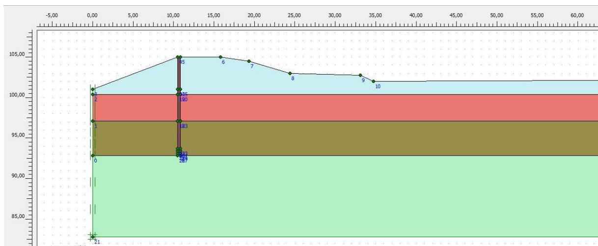
22. ábra: Modellgeometria a vízáró fal közvetlen környezetében
