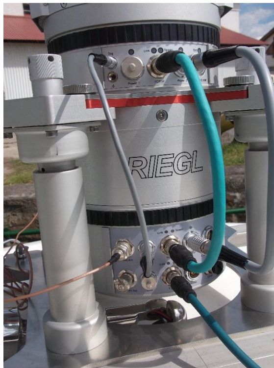
10. ábra- Kábelek bekötése
