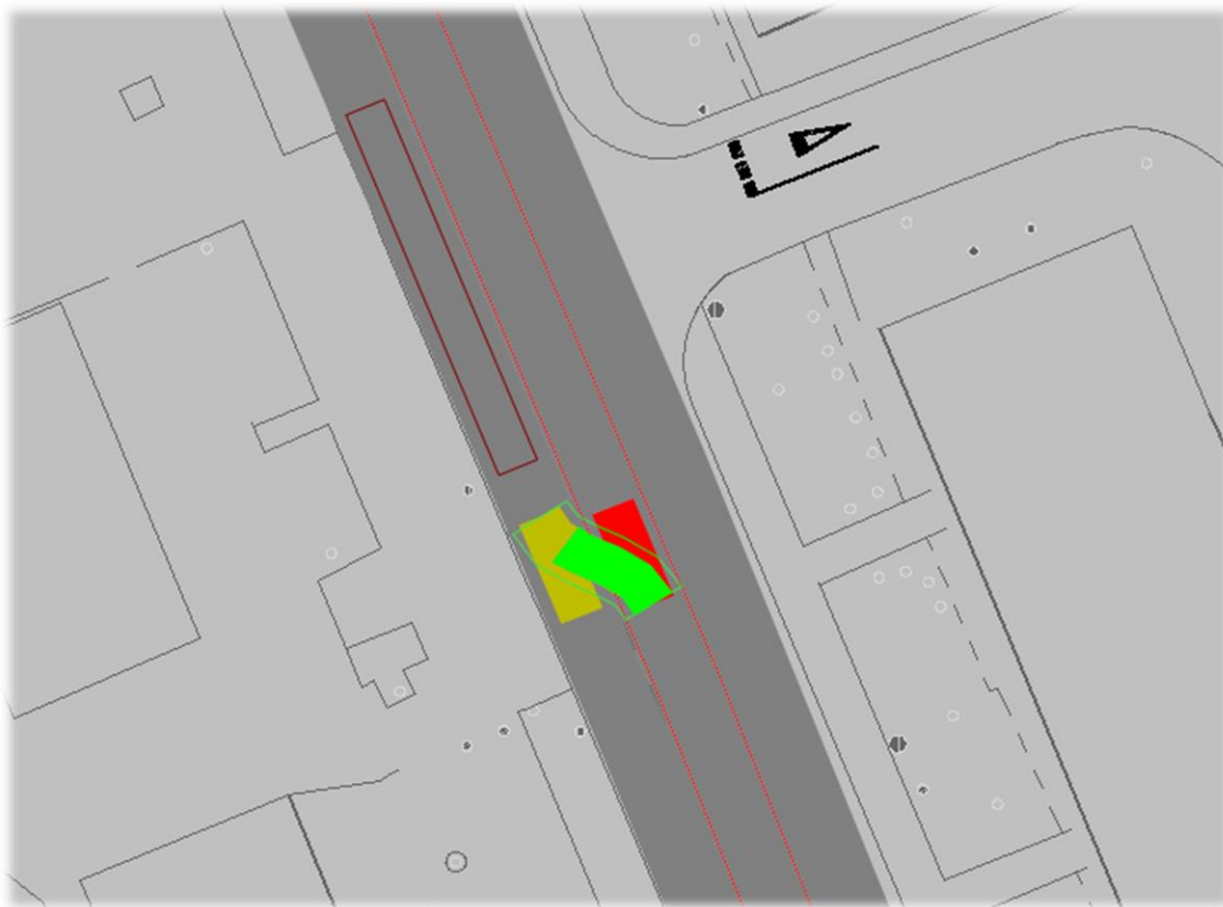
22. ábra: Tömegközlekedési eszköz előnyben részesítésének beállítása a Vissim-ben, a konfliktus zóna beállításával (saját szerkesztés)
