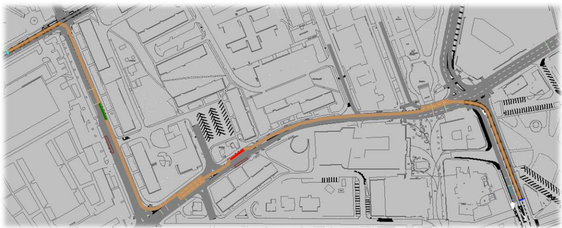
24. ábra: Egy buszjárat útvonalának szemléltetése; a megállóhelyek beállítása a Vissim-ben (saját szerkesztés)
