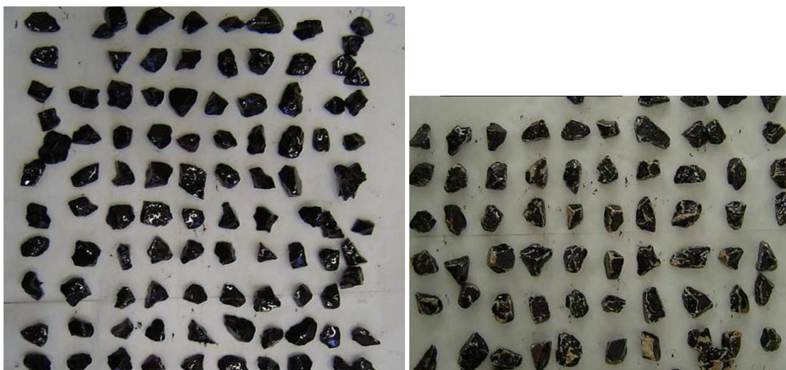
21. ábra: A kémiailag stabilizált gumibitumen (balra) és a venezuelai kőolajból előállított 50/70 bitumen (jobbra) tapadása dolomiton 4 órás forgó palackos teszt után.
