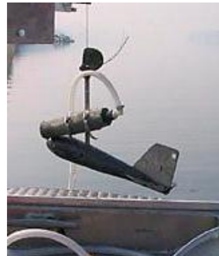
3. kép: A szivattyús hordalékmérő víz alatti egysége
