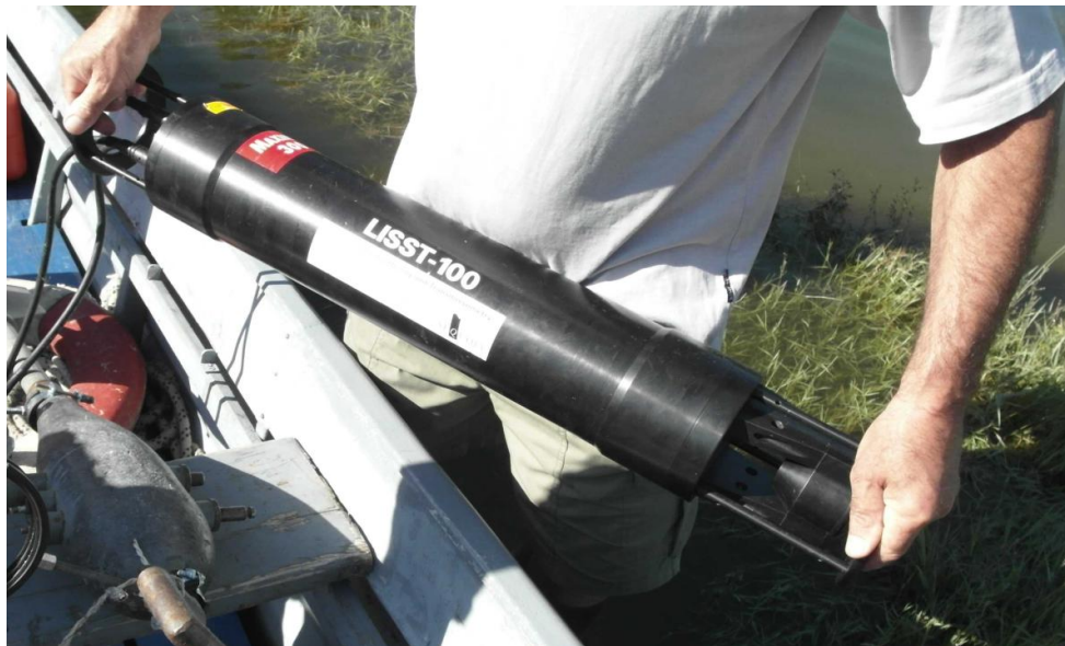
5. kép: A lézeres elven működő LISST-100 műszer.
