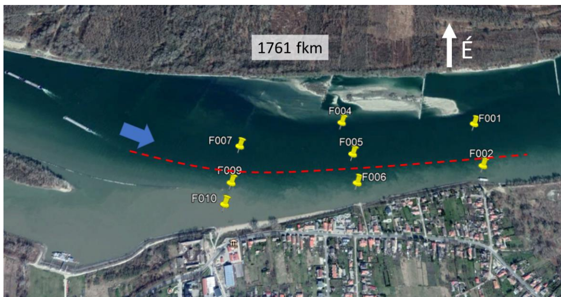
29. ábra: A vizsgált függélyek elhelyezkedése a gönyői mérés során (2018.06.22.)
