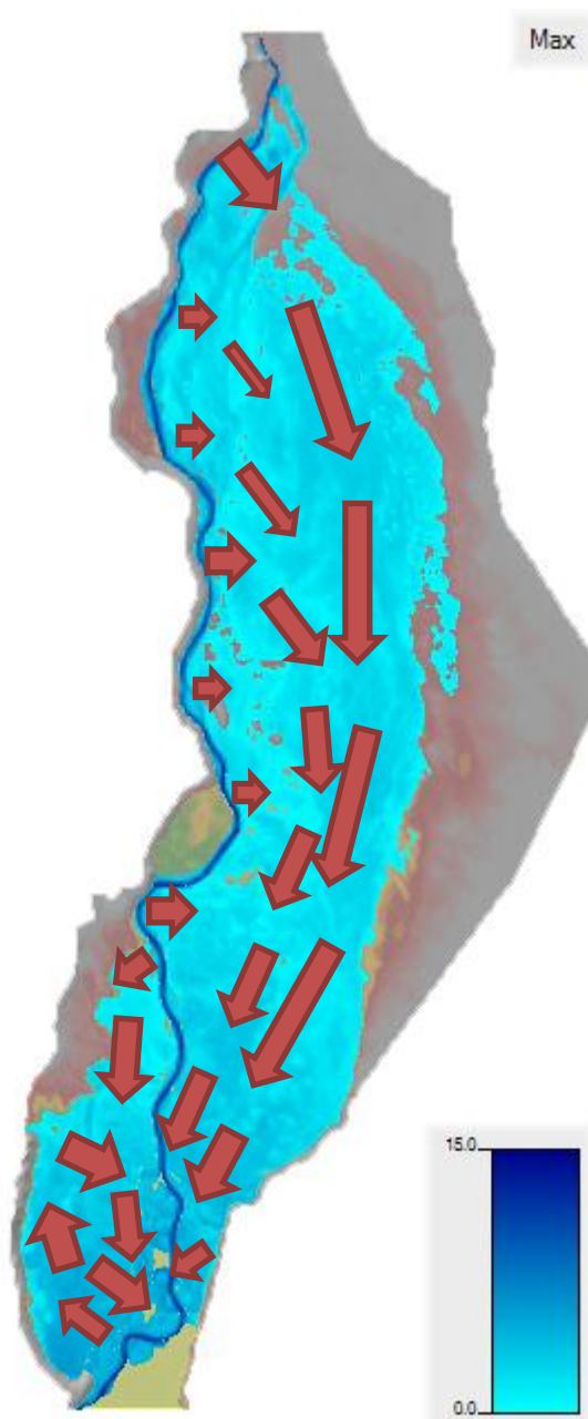
12. ábra 100 000 éves árvíz maximális vízmélységei MÁSZ+1m-es töltés kialakítás mellett, valamint a jellemző áramlási útvonalak (piros nyilakkal jelölve).
