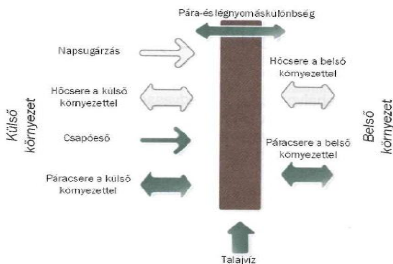
5. ábra: Határoló falszerkezetet érő hő- és nedvességhatások [15]
