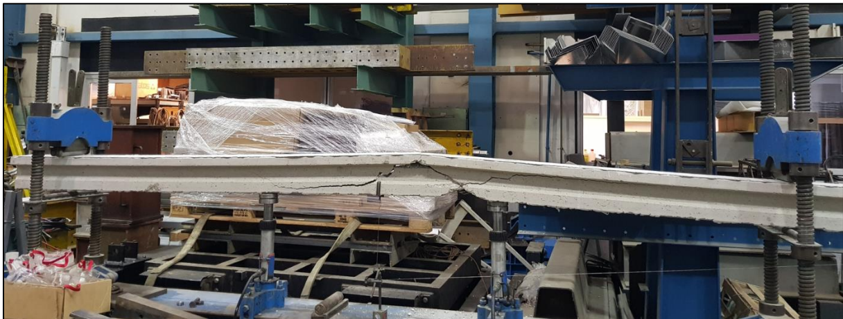
13. ábra – Valós kísérleti elrendezés és tönkrement gerenda képe 4
