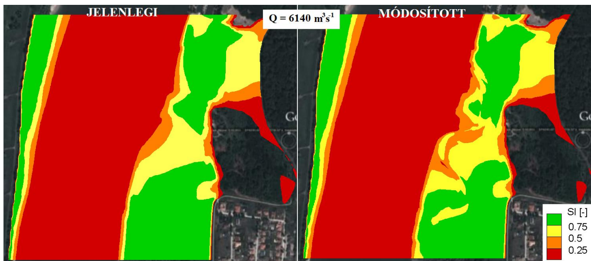
24. ábra – Alvízi műveknél számított megfeleléségi indexek (nagyvíz)
