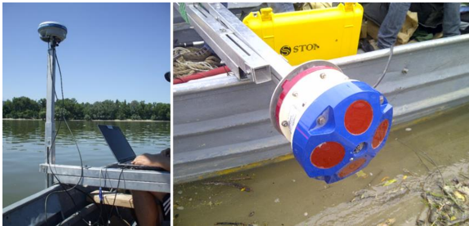
9. és 10. ábra – ADCP-hez kapcsolt GPS jelvevő és az adatfeldolgozó számítógép /Saját fénykép/; Négy fejes ADCP műszer /Saját fénykép/
