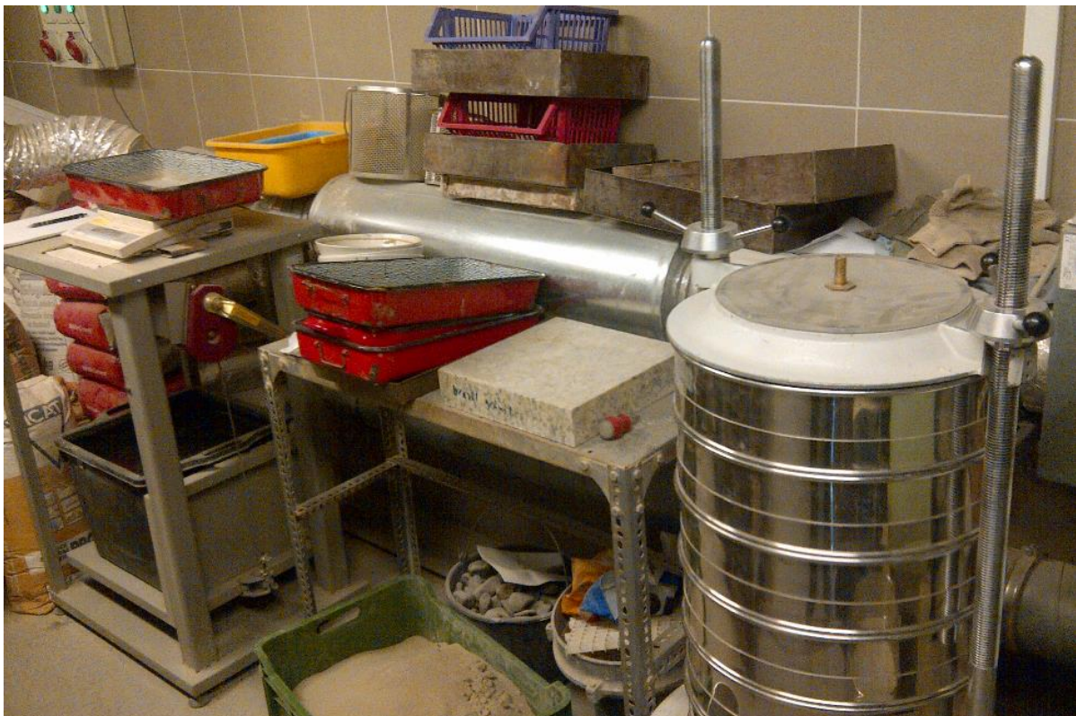
16. ábra – Mederanyag minta laboratóriumi vizsgálata szitasorral /Saját fénykép/
