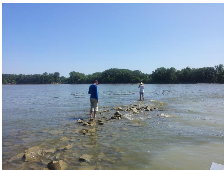
11. ábra – Sarkantyú koronaszint mérése RTK GPS-szel /Készítette: Baranya Sándor/
