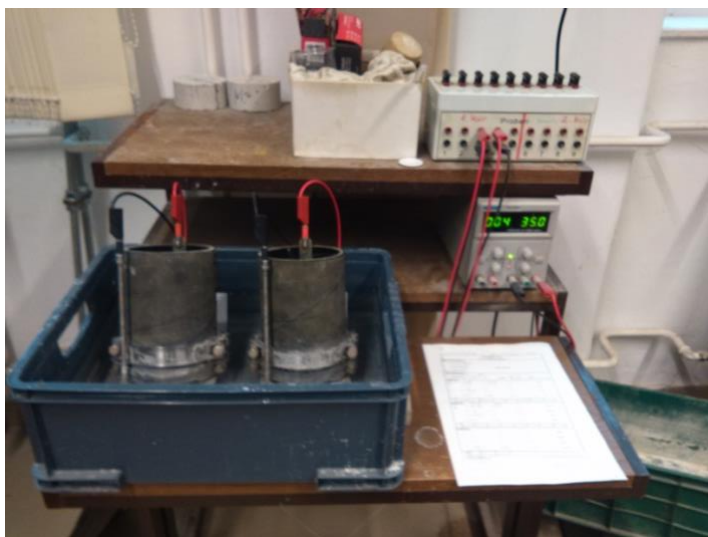
Kép 5.3-7: A kloridion migrációs vizsgálathoz használt eszköz (saját fénykép)
