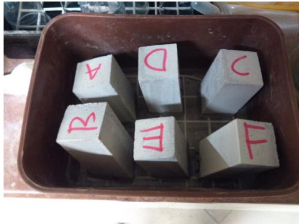
Kép 5.3-5: Kapilláris vízfelvétel mérése (saját fénykép)
