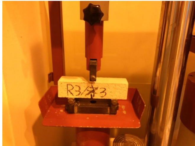
Kép 5.3-3: Hajlítószilárdság mérése (saját fénykép)
