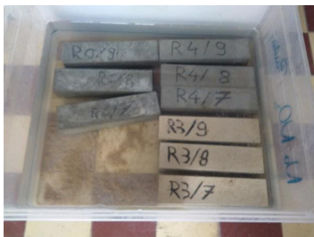
Kép 5.3-6: Teljes elmerítéses vízfelvétel (saját fénykép)
