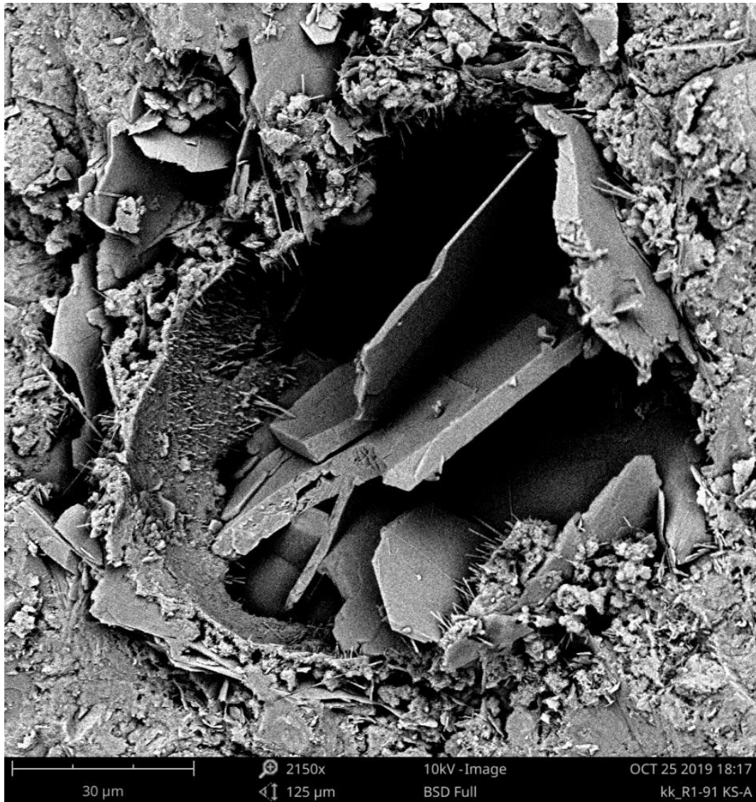
Kép 6.6-5: R1 cementpép, pórus, 8 hétig tartó pH = 1 kénsavban történő tárolást követően, M=2150x (saját felvétel)
