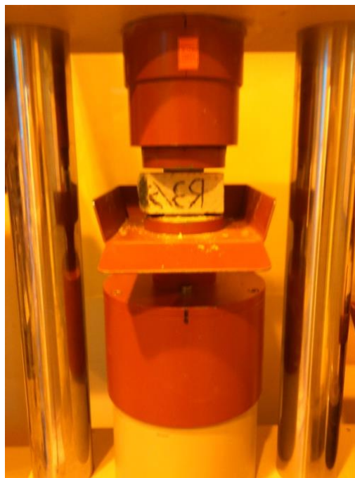
Kép 5.3-4: Nyomószilárdság mérése fél próbatesten (saját fénykép)
