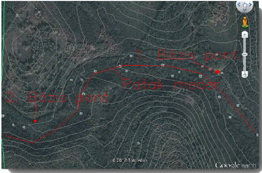
5. ábra Utófeldolgozással meghatározott alappontok elhelyezése
