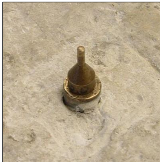
ábra 9: fém adapter, melyre a magassági méréseket végeztük el (jelmagasságuk előre meghatározott).
