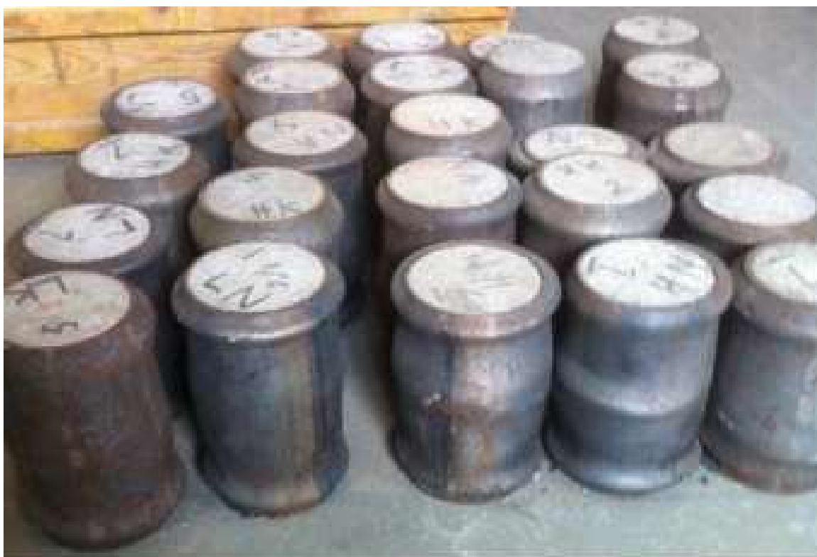
52. ábra –Kísérleti CFST próbatestek tönkremeneteli módja
