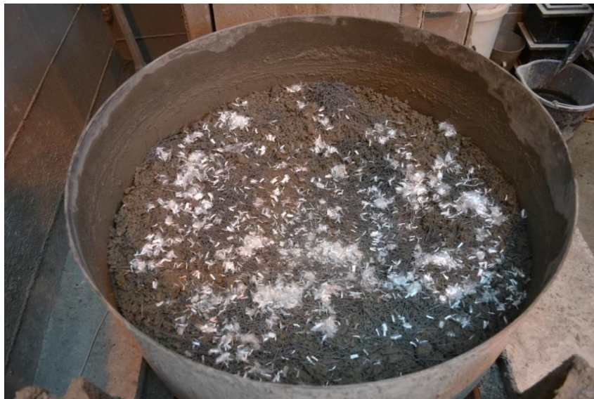
5.1. ábra: Betonkeverék Mapefibre St42 és Mapefibre Ns12 szálakkal
