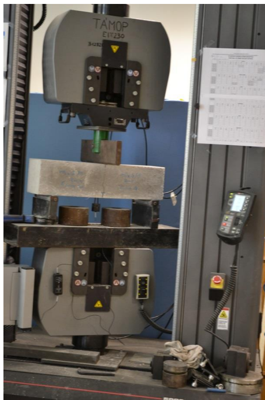
5.5. ábra: Középpontos hajlító-húzó vizsgálat INSTRON 5989 típusú törőgéppel
