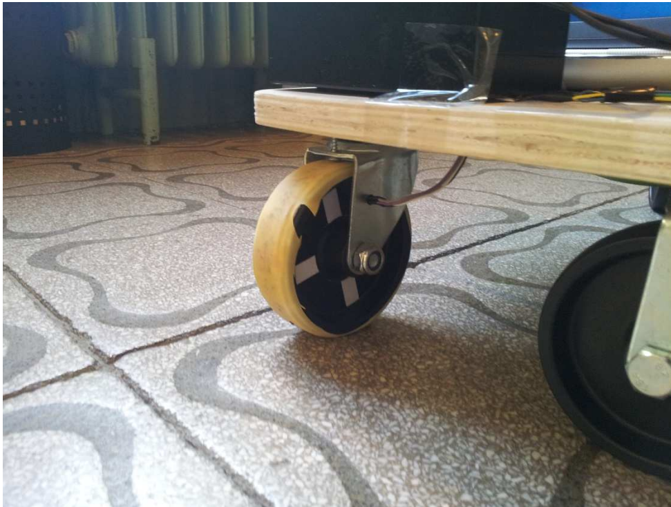
16. ábra A megváltoztatott futófelület és kerékminta
