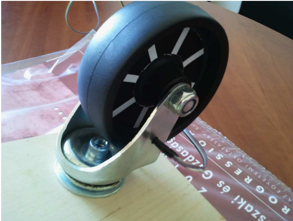
12. ábra A kerékre rögzített kerékminta és szenzor
