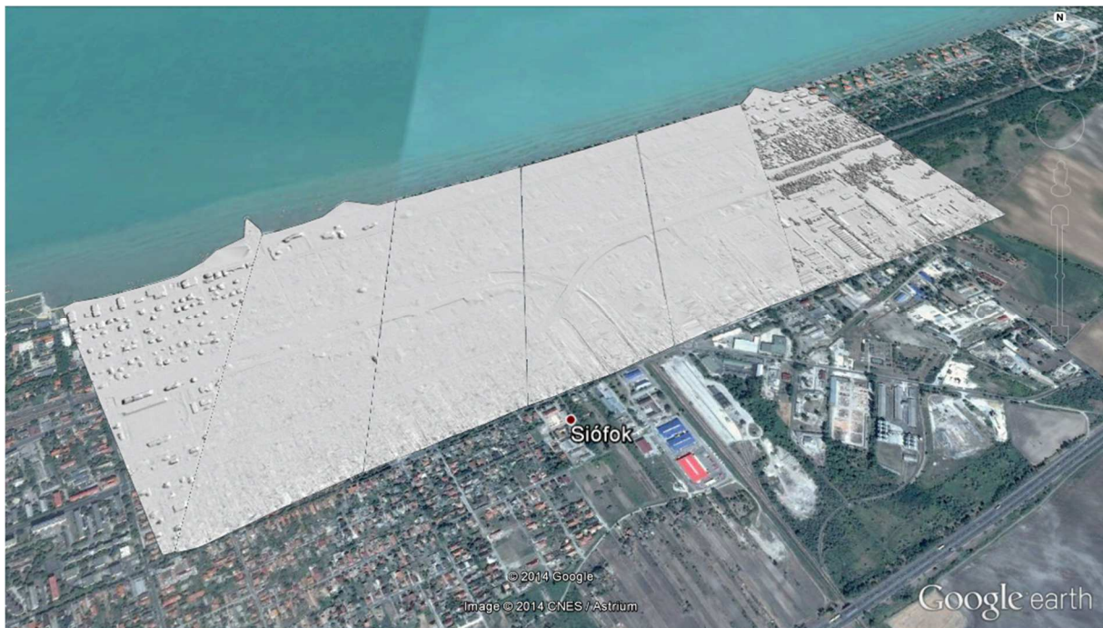
8. ábra: DTM a különböző talajszintképzések alapján (wilderness, nature, town or flats, city or warehouses, metropolis) és DFM
