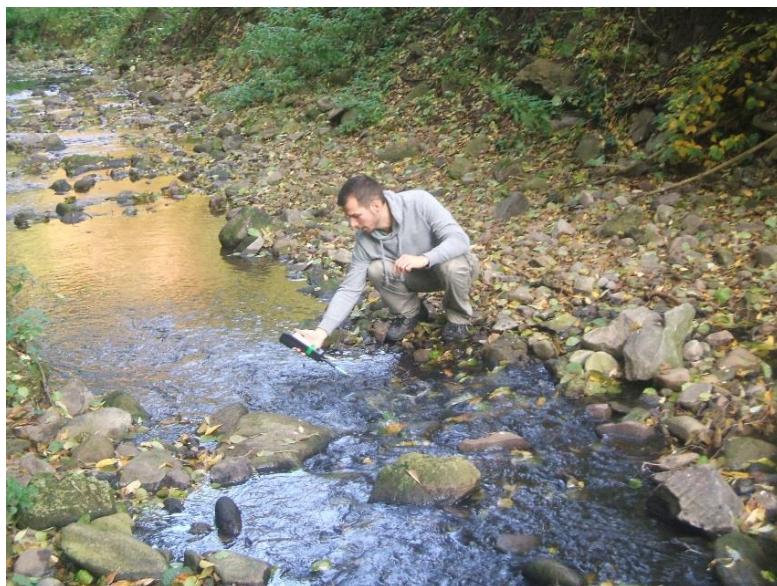
7. kép: Vezetőképesség mérése konduktométerrel
