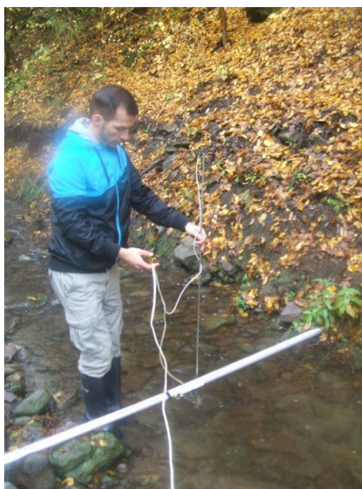
9. kép: Forgószárnyas sebességmérés (vízhozam-mérés)
