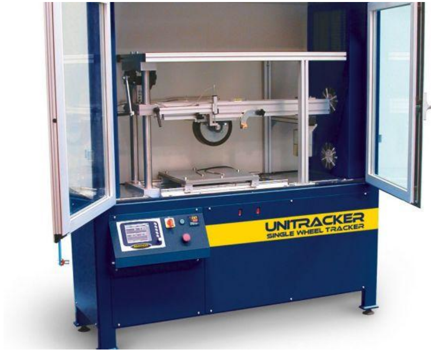
6. ábra: Nyomvályúsodást vizsgáló készülék [20]
