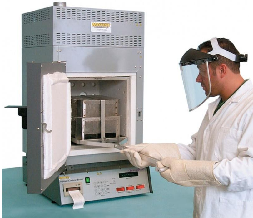
5. ábra: NCAT típusú égetéssel bitumentartalom meghatározó készülék [20]
