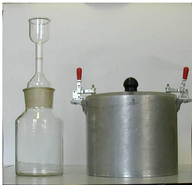
3. ábra: Piknométer és vákuumedény [15]
