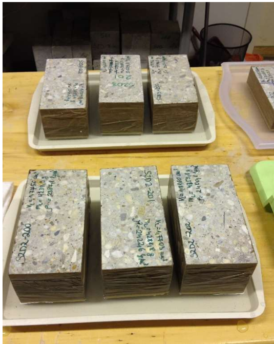
12. ábra: vízfelszívás mérése és elve
