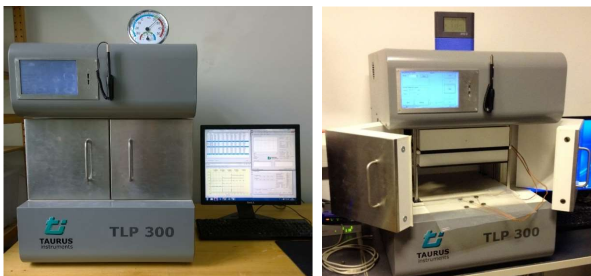
5. ábra: hővezetési tényező mérése, Taurus TLP 300 DT(X)
