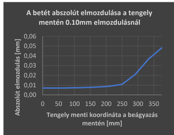
16. Diagram: Bordázott betonacél abszolút elmozdulása a beágyazás hossza mentén 0.10mm terhelő elmozdulásnál
