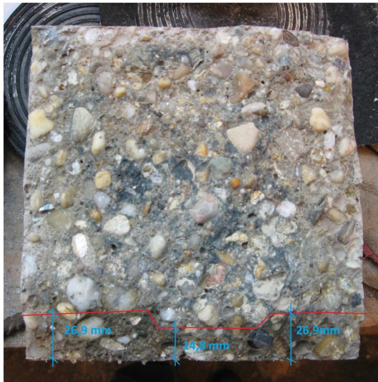
4.13 ábra: Vízbehatolási mélység a szigetelt kockán (saját felvétel)
