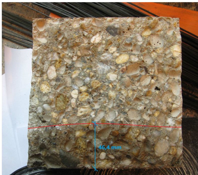
4.12 ábra: Vízbehatolási mélység a szigetetlen kockán (saját felvétel)
