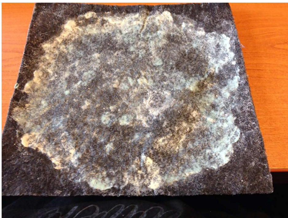
4.10 ábra: 20x20 cm-es vízszigetelés próbadarab (saját felvétel)
