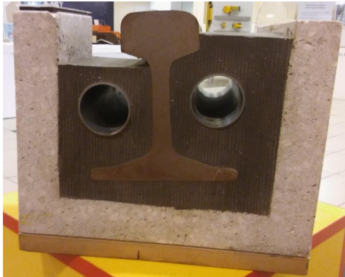
30. kép: Vignol sín és kiöntéses leerősítés, kiöntőanyag megtakarításra alkalmas PVC csövekkel
