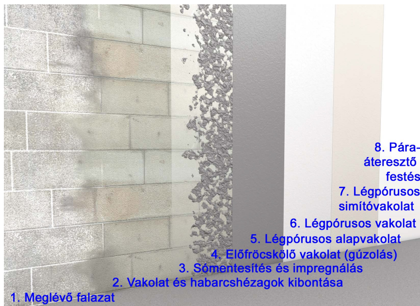
20. ábra. Légpórusos vakolatrendszer felépítése [www1.]
