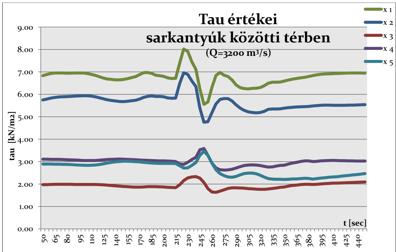
58. ábra Tau értékei sarkantyúk között, Dr_{ft}=2.50\text{m} ; v=1.60\text{m/s}
