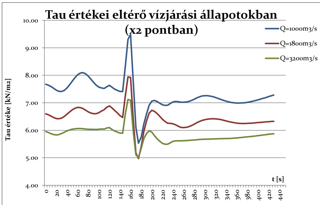
99. ábra Vízjárások vízszint ingadozásai x2 pontban ; Drft 2.50m + v=2.10m/s
