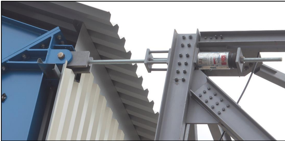
11. ábra A terhelő sajtó csatlakozása a kerethez
