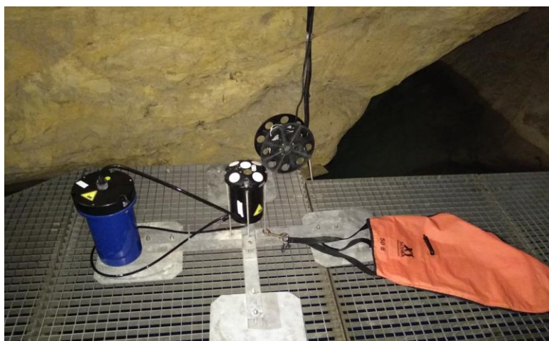
24. ábra Signature a mérési pontba való elhelyezés előtt az emelőballonnal
