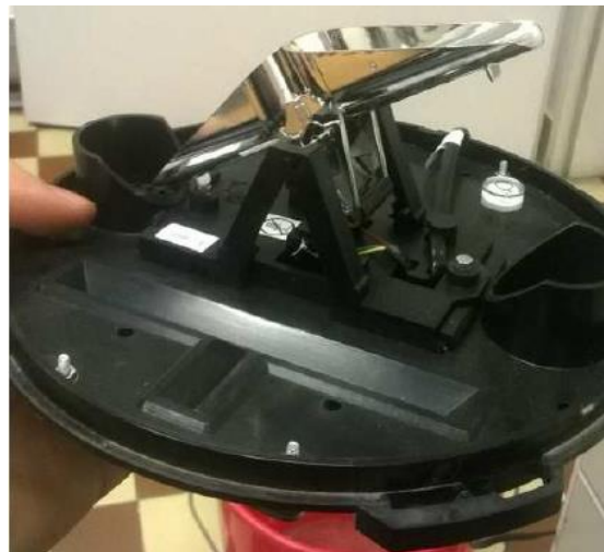
17. ábra Táróban felszerelt billenőedényes csapadékmérő (Tóth, 2017)
