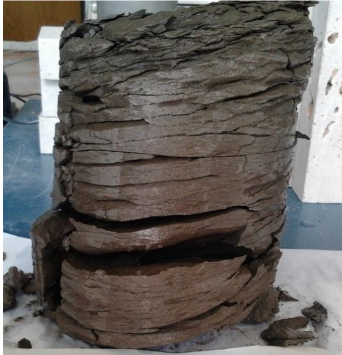
4. ábra: Telítés közben szétesett próbatest
