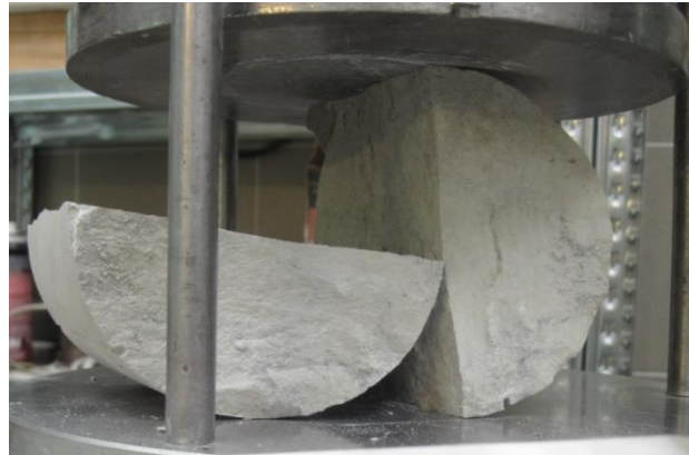
16. ábra: Jellegzetes töréskép (BSz-2/7 jelű próbatest)
