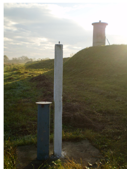
11. ábra: Vízállásészlelés rézsús és álló lapvízmércén, talajvízszint figyelő kút
