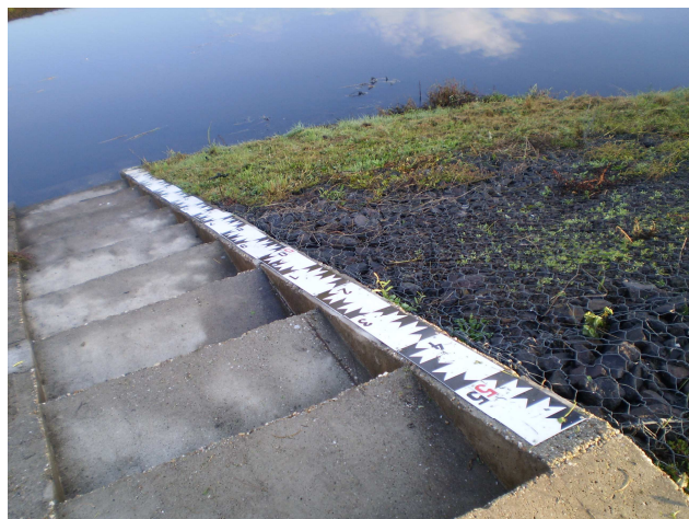
11. ábra: Vízállásészlelés rézsús és álló lapvízmércén, talajvízszint figyelő kút
