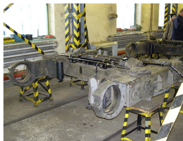
(b) Az MX/A motorkocsi forgóváza [47]
