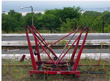
(b) Amikor balul sülnek ki a dolgok: egy törött áramszedő [45]
