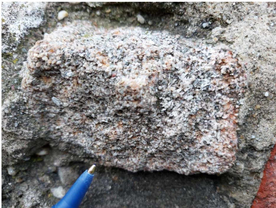
6.22. ábra. Barnás-rózsaszín színű, durva szemű kvarc homokkő jól osztályozott szögletes (1mm-es és annál nagyobb méretű) kvarcsezemcsékkel (6.18. ábra 37. kőzet)
