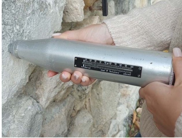
5.2. ábra N-34 típusú Schmidt-kalapács mérés közben
