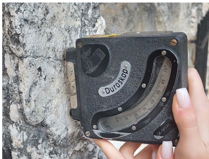
5.1. ábra Duroskop mérés közben
