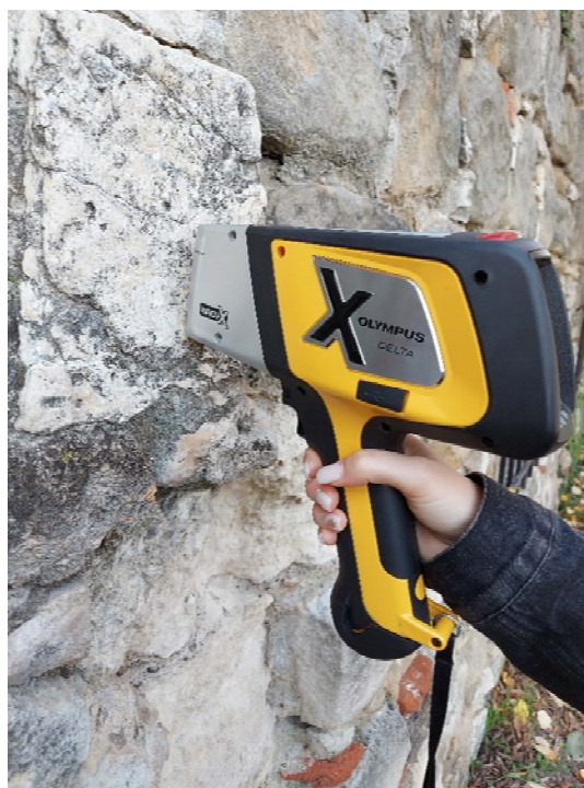
5.4. ábra Hordozható XRF mérés forrásvízi mészkövön
