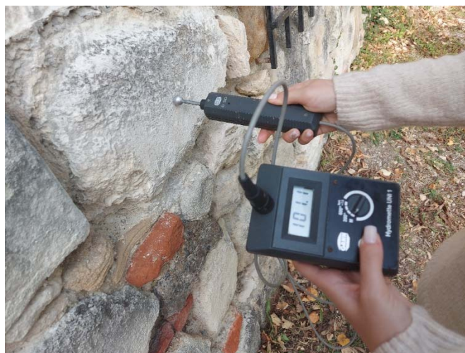
5.3. ábra Nedvesség mérés a Budai vár falzatán
