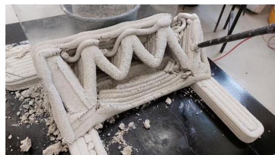
13. ábra: Kis boltíves födém numerikus szimuláció és kísérlet
