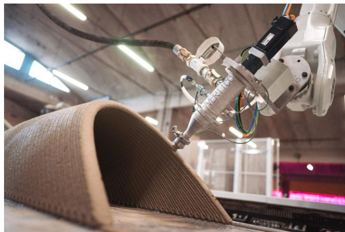
5. ábra: Kis boltíves elem nem síkbeli betonnyomtatása (Forrás: Vertico)
