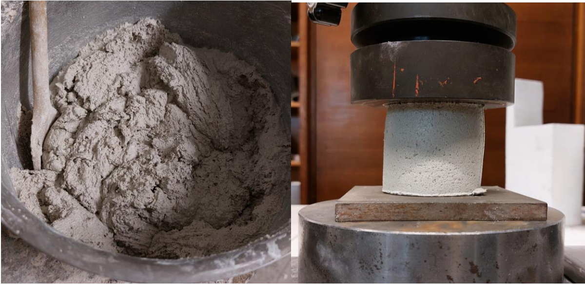
24. ábra: A 6. receptúra keverés és nyomóvizsgálat közben.
